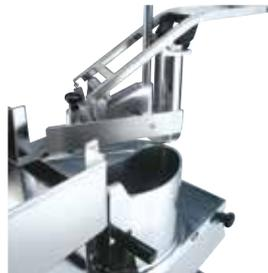
Tolva accionada mediante palanca. Movimiento vertical de la palanca para mayor ergonomía y ahorro de espacio.
